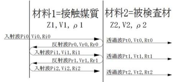
に比べて高いので、接触媒質内反射での位相反転は生じない。一方保護膜は探触子によって設計方法が異なり、振動子より音響インピーダンスが高い場合と低い場合がある。また、接触媒質も音響インピーダンスの高いのがある。3つの組み合わせの例を右に示す。これらは振動子の共振と同じであり、
