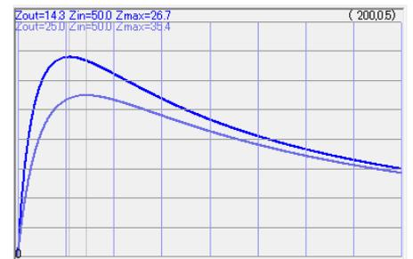
縦軸は効率で、横軸は 0~200 Ω の探触子インピーダンスである。送受信回路の入出力インピーダンスの並列値と探触子のインピーダンスが概略一致する場合、探触子での消費エネルギーが高くなる。出力インピーダンスを 20 Ω の場合は 27 Ω 程度で最大消費となる。下の図は受信回路の入力インピーダンスを 1k Ω 一定おした場合である。
