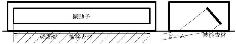
のペイントブラシ型探触子の振動子は 1/2×2 インチ (12×48 mm) とアスペクト比は 4 程度です。これは市販の探傷器と電気的特性を合わせるのに無理があるからです。自動探傷ではアスペクト比は 20 程度まで使われています。例えば 10×100 mmです。探傷器は専用ですので、探傷器側の電気的特性が容易に変えられるからです。最近では 1-3 コンポジット振動子などが販売され、波数の少ない波形の発生と電気的対応範囲が広がったので、市販探傷器に適合したペイントブラシ型も出来るようになりました。
