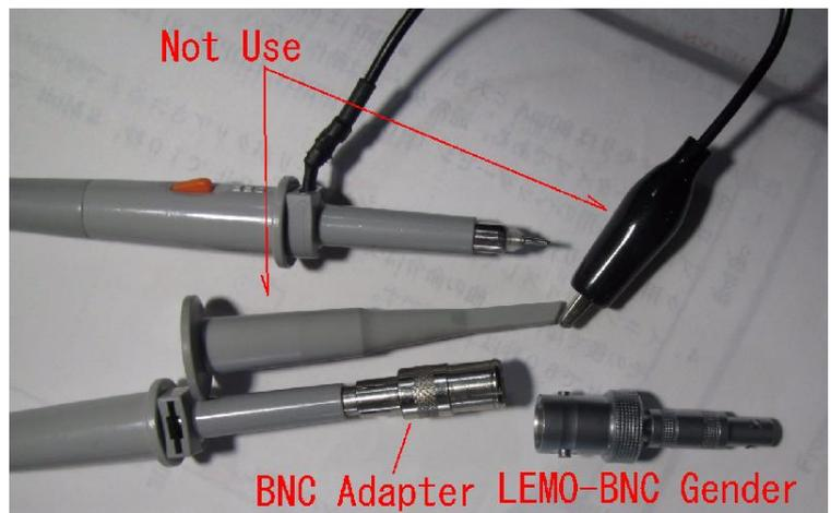
プローブに付属している BNC アダプターと LEMO 変換器など使い、最短の計測経路と成るようにする。リード線が付いた GND 用のクリップなど使うのはもっての外である。
