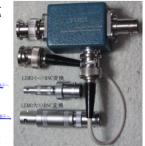
圧が伝わるのを防ぎ、オシロすコープを壊す恐れはありません。標準型 CM10a は送信 電圧 600V までの  $0.1\sim50 \mathrm{MHz}$  の帯域の市販探傷器、パルサーレシーバに対応しています。この約 10 倍の電力を CM10Ha は伝えることができます。
