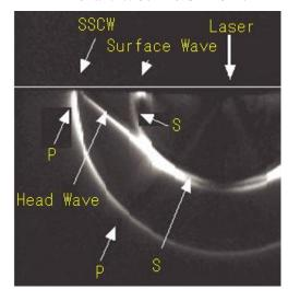
はガラス質(橄欖岩、大陸地殻は安山岩などで音速 6km/S、海洋地殻は玄武岩などで音速 7km/S、ガラス 5~6km/S)で出来ている。透明なガラスの表面に強いレーザーを照射し、音波を発生して音の伝わり方の観測をすると、均質と仮定した地殻の音波伝搬の良い模擬になる。右図の Laser と書かれた部分にパルス状レーザーを照射し応力波を発生させ、一定時間経た時の歪即ち音波を観測したものである。超音波可視化法と言う。P 波はレーザー照射点から一番離れた位置に到達している。地殻は薄く、多層状の異なる材質なので、下方向に向かった P 波は実際には一部反射する。P 波の表面近くは P 波の応力によって表面が凸又は凹になる。物に一方向に応力を加えると、直角方向にも歪む。
