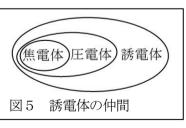
焦電体は温度変化により電極に電荷が発生する現象で圧電体の殆どが大なり小なりこの現象を生じ、その性質が目立つものを焦電体と呼んでいる。焦電体圧電体誘電体の関係を図5に示す。
