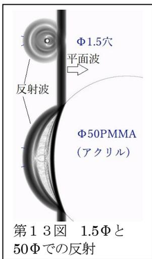
なお、大きな穴にはアクリルが埋め込まれ片側が導電性処理されている。これは水晶時代に水晶振動子の表電極として対象の金属を使ったため必要であった。今は必要ない。また、厚さが 23 mm で本体の 25 mm より薄い。これは鋼の縦波で 50 mm 相当になり、校正にも使われた。今はアクリルが無い試験片が販売されている。
