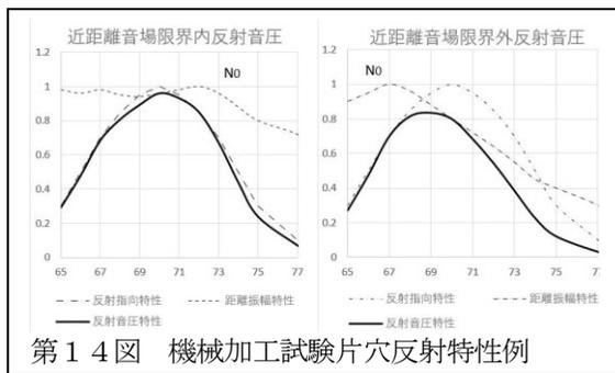
第 1 4 図 機械加工試験片穴反射特性例
