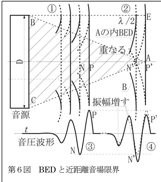
振幅の高い正 P と負 N の波は P' と N' となる。P' は BED にエネルギーが流れるから振幅が多少減るかもしれない。N' の平面波部分もやはり BED にエネルギーを与えて減るであろう。が P が発生した内側の BED が重なり増える。四角形の音源の場合上下左右からの BED が重なる。円形音源では全周からの BED が中央に重なる。その為振幅がより増える。④の様に変化する。この状態が近距離音場限界である。図の ABE の三角形と  $\lambda/2$  から近距離音場限界距離 N を導くと
