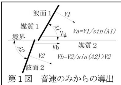
第1図で媒質1内の平面音波1が境界に当たり、媒質2内に音波を伝搬したとする。媒質1内の波面が境界を移動する速さ  $Va$  は、入射角を  $A1$ 、媒質1内音速を  $V1$  として
