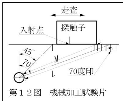
第 1 2 図 機械加工試験片
