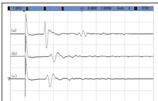
第4図 コンクリート切片の透過試験
