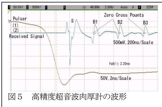
図5 高精度超音波肉厚計の波形
